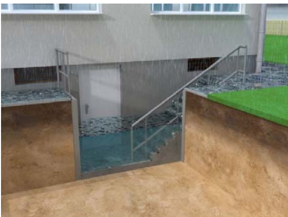
GE-RS Oberflaechenwasser Treppenabgang Schaden
