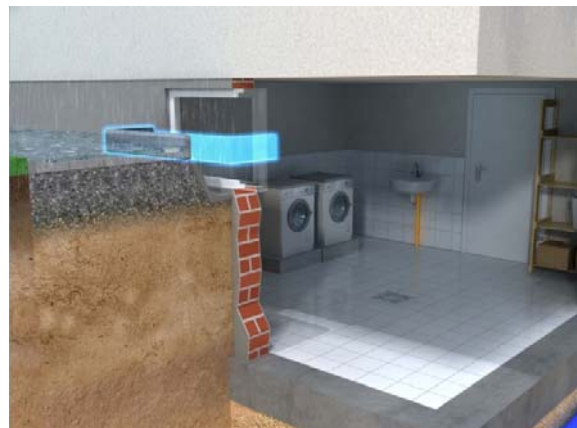
GE-RS Oberflaechenwasser Lichtschacht Schutz
