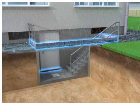
GE-RS Oberflaechenwasser Treppenabgang Schutz
