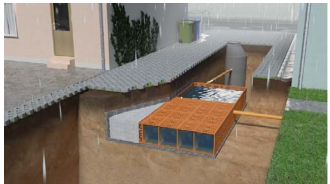
GE-RR 04-05 Versickerung Retentionsmodule-02
