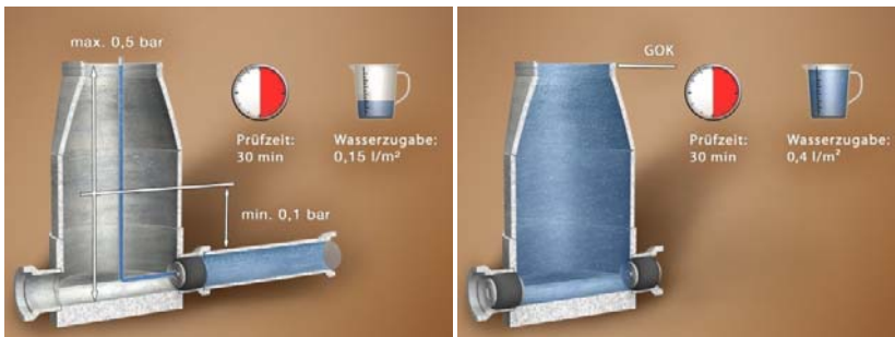
GE Dichtheitspruefung Richtlinien DINEN1610 Kanal / Schacht
