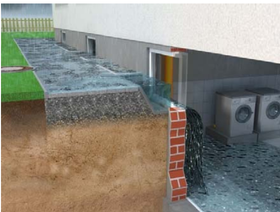
GE-RS Oberflaechenwasser Lichtschacht 02 Schaden
