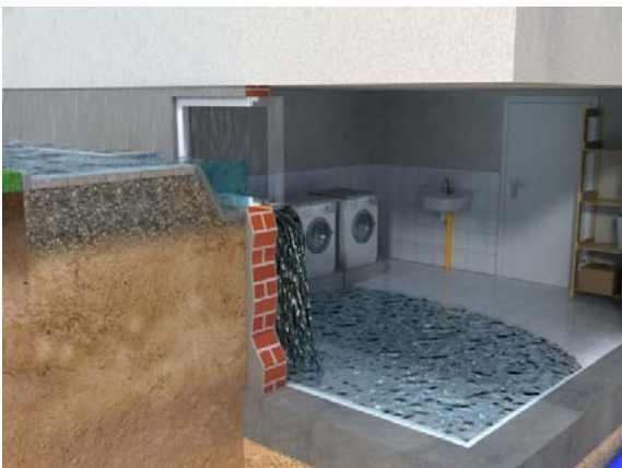
GE-RS Oberflaechenwasser Lichtschacht Schaden
