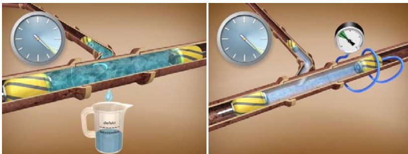
Dichtheitspruefung Prinzip Wasser / Luft
